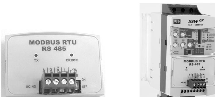
Utilizando a interface RS-485, o mestre pode controlar diversos drives conectados em um mesmo barramento. O protocolo Modbus-RTU permite a conexão de até 247 escravos (1 por endereço), desde que utilizados também repetidores de sinal ao longo do
