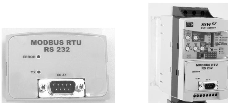
Esta interface possibilita a ligação de um mestre a uma Soft-Starter SSW-07/SSW-08 (ponto a ponto) em uma distância de até 10m. Para comunicação com o mestre, deve-se utilizar um fio para transmissão (TX), um para recepção (RX) e uma referência (terra).
